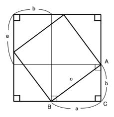
BC=a、CA=b、AB=c として、図のように 2本の線を引く。 大きな正方形の面積を 2通りの 方法で表す。 1) (4個の直角三角形)+(辺が c の 正方形) {(a×b)÷2}×4+c×c・・・① 2) (辺が aの正方形)+(辺が bの 正方形)+(2辺が a、bの長方 形)×2 a×a+b×b+(a×b)×2・・・② (1)=②より、 a×a+b×b=c×c
